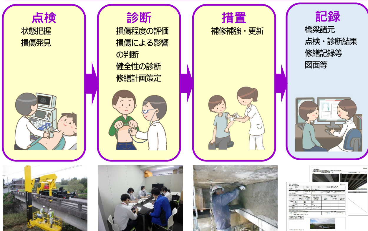
図 3.1.1 橋梁のメンテナンスサイクル
