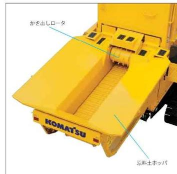
高い定量供給性能の原料土供給機構
