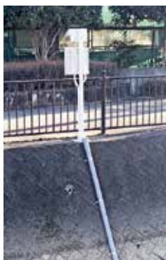
IoT実証実験の一つ 《LPWA利用の水位計》
