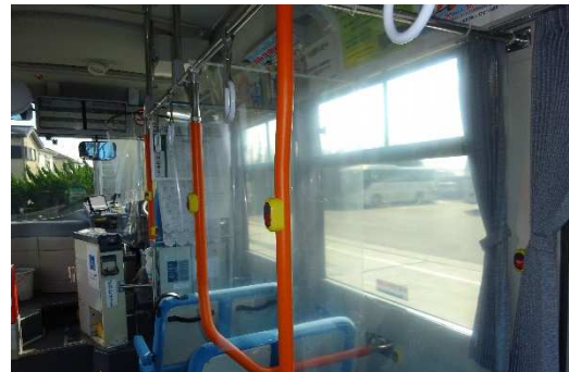
感染防止シートを設置した車両
