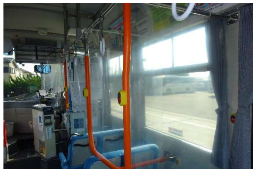
感染防止シートを設置した車両
