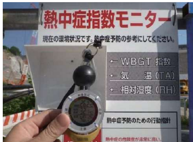
作業箇所毎の熱中症計設置
