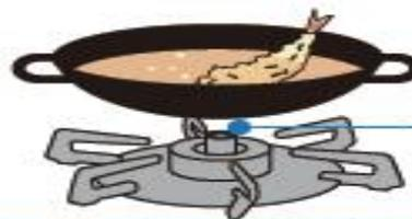
センサーが鍋底の異常な過熱を感知。油の温度が上がりすぎる前に自動で消火します。
