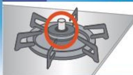
センサーが鍋底の温度を感知し、約250℃になると自動的に消火して油の発火を防ぎます。
