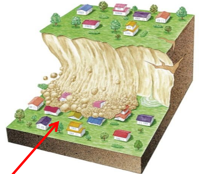
くず がけ崩れ ※急傾斜地崩壊
