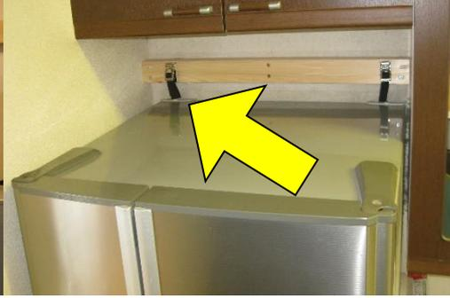
冷蔵庫の上部持手部分に専用ベルトを通し取付ます。
