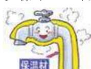
▼破裂の防止策／水道管に毛布や保温材を巻き、その上からビニール袋などを巻いて
