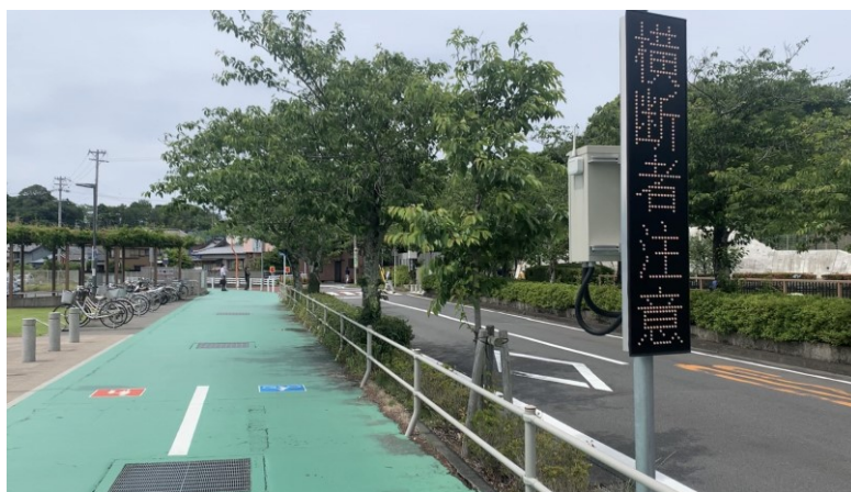
横断歩道の歩行者をセンサーで感知しドライバーに知らせるシステムの運用（蓮華寺池公園）
